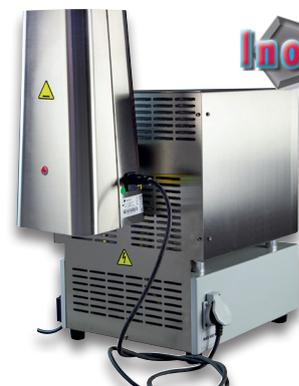
Dispositif simple qui se branche à tuyau de l'évacuation de fumées de n'importe quel four de chauffe pour éliminer les gaz des produits non brûlés générés dans le four lors de la combustion des cires ou autres matériaux.
