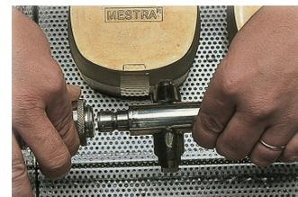
Système rapide de démontage et de montage de l'arbre d'aspersion.
