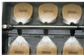
Le système de nettoyage à 6 injecteurs d'eau sous pression assure un bon ébullantage des mouffles ainsi qu'un parfait décollement de la cire.
