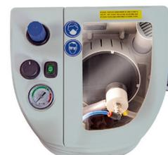
Les squelettes se placent dans un panier tournant grâce à l'action d'un moteur.
