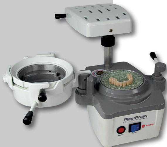
La thermoformeuse à pression positive la plus compacte du marché. Meilleure fidélité de copie et moins de bruit par rapport aux thermoformeuses à vide. Pratique et polyvalente, elle accepte des plaques rondes et carrées jusqu'à 6 mm d'épaisseur. Elle doit être reliée à un compresseur (entre 3 et 8 bar).
