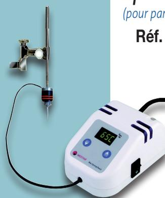
Avec une tige de fixation de 3, 2,35 ou 2 mm de diamètre (préciser le diamètre lors de la commande). Insertion idéale sur un paralléliseur, une fraiseuse ou dérivé pour modeler la cire sur les modèles. La spatule est fournie avec un assortiment de pointes et avec un boîtier de contrôle électronique qui permet de régler très précisément la température de travail, indiquée sur le display digital.
