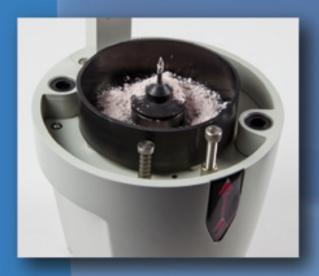
Du fait de la poussière qui se produit pendant le travail, la machine doit être conçue pour être facile à nettoyer. Dans le modèle Atlas, la table peut être démontée très aisément et sans aucun outil spécial, pour avoir accès au récipient situé à l'intérieur qui recueille toute la saleté déposée. Ce récipient peut être ensuite nettoyé avec de l'eau et du savon avant d'être remonté dans la machine.
