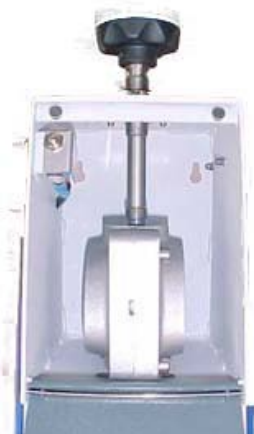
(Fig. 1) Détail de l'emplacement du moufle
