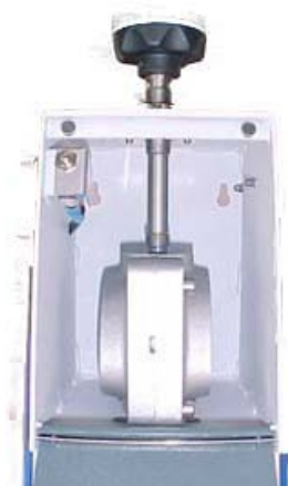
(Fig. 1) Detalle colocación de la mufla
