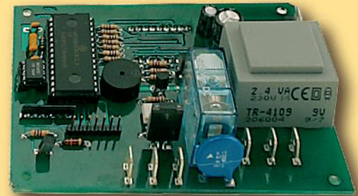
Un control electrónico con microprocesador y display de 7 segmentos, se encarga de regular las funciones de la máquina. Cabe destacar el aviso automático de cambio de lámparas cada 500 horas de funcionamiento.
