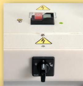
Mediante un interruptor de fácil acceso es sencillo seleccionar el modo de trabajo del box: iluminación + aspiración, o sólo iluminación. Además, el box incluye un interruptor de seguridad con rearme manual, lo que permite adaptar modelos antiguos de pulidora a la Normativa de Seguridad.
