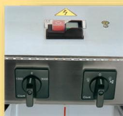
El Box incorpora 2 interruptores, más uno de seguridad. El 1º acciona el motor a 1.500 ó 3.000 r.p.m.. El 2º acciona luz o luz y aspiración. El interruptor de seguridad interrumpe la llegada de tensión al motor si ha habido un corte de suministro eléctrico teniendo que rearmararse manualmente.
