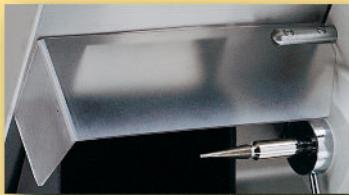
Protector, fabricado en policarbonato satinado impide toda proyección por la parte superior de la pulidora. Su enclavamiento permite un giro de 85º.
