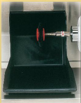
Protectores extraíbles y lavables. Fabricados en goma sintética flexible, amortiguan posibles roturas de piezas, por escape.
