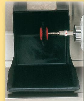
Como elementos de seguridad en el área de pulido, la máquina cuenta con viseras fabricadas en policarbonato y protectores de goma sintética extraíbles y de rápida limpieza.
