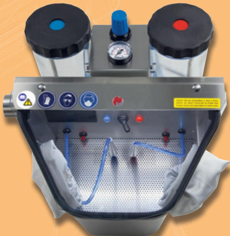
La valve de changement de silo de sable est située à l'intérieur de la cabine. Les couleurs permettent d'identifier et de sélectionner rapidement le sable désiré. Pour le réglage du jet, on peut utiliser la partie en caoutchouc située à l'intérieur sur une paroi de la cabine de sablage.
