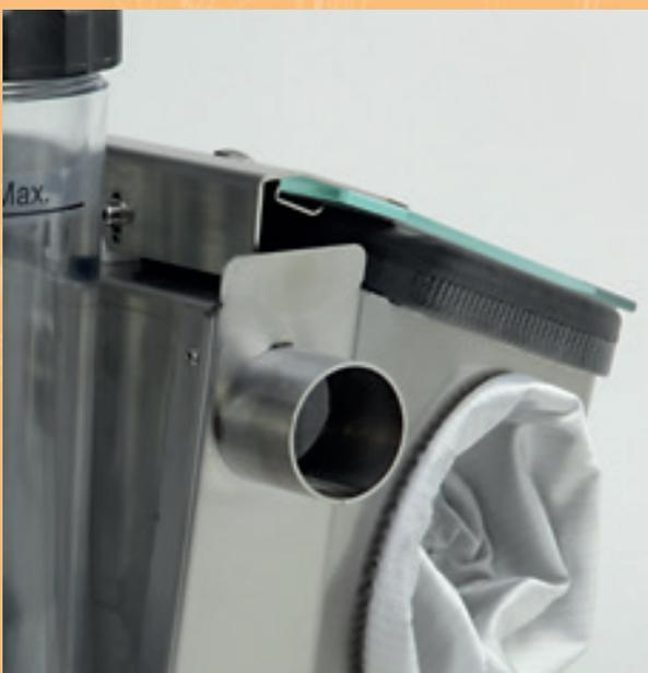
La sortie de la poussière de l'intérieur de la sableuse est matérialisée par un tube situé dans la partie latérale de la machine dont le diamètre le prédispose à une aspiration professionnelle à même d'aspirer le type de poudres abrasives utilisées. **MESTRA** vous recommande les références **R-080532 Eolo plus** ou **R-080539 Gemini**.
