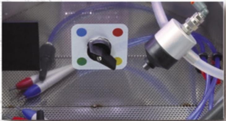
Le bouton de changement de silo est situé à l'intérieur de la chambre. Le critère des couleurs permet d'identifier et de sélectionner rapidement le silo souhaité. Pour le premier ajustage du jet on peut utiliser une plaque de choc en caoutchouc située également à l'intérieur de la chambre.
