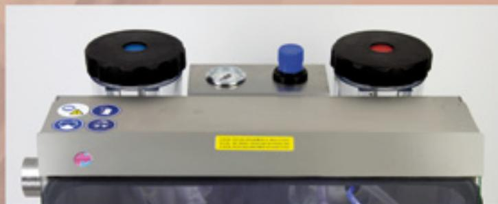
Toutes les commandes de la partie inférieure de la machine (boutons-poussoirs, manomètre, etc...) sont protégées par des soufflets et recouvertes de silicone.
