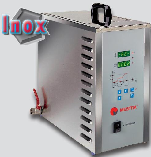
El mayor problema que se origina en un laboratorio, en la técnica de polimerización, es la condensación de vapor producida por la ebullición. Grados de humedad muy altos son perjudiciales para la salud y para las cosas. MESTRA ha amortiguado dicho efecto dotando a la polimerizadora de un control preciso, que permite programar temperatura de décima en décima de grado, pudiendo calentar el agua a 98,5° sin que se produzca ebullición, no afectando a la calidad de la polimerización.
