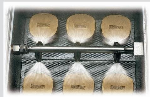
El sistema de lavado por 6 inyectores de agua a presión nos aseguran un buen escaldado de las muflas y un desencerado perfecto.
