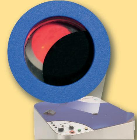
En la parte superior de la máquina se encuentra una mirilla que permite observar la textura de la aleación mientras se está fundiendo, para que pueda ser colada en el momento apropiado. Un cristal con filtro UV protege los ojos durante la visión.
