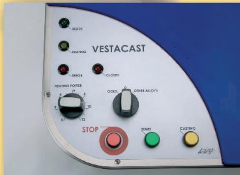
El cuadro de control es de tipo sinóptico permitiendo un manejo intuitivo. Tres botones de mando y un potenciómetro con el que se regula la potencia de fundido, son suficientes para realizar el colado. La temperatura de fusión puede llegar a alcanzar los 1750 °C. El estado del proceso se visualiza a través de cuatro lamparitas indicadoras.
