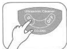
5. Appuyer sur la touche "ON" pour commencer le nettoyage. Le voyant bleu s'allumera et on entendra un bourdonnement. Le nettoyage s'arrêtera automatiquement après 5 minutes. Si nécessaire on prolongera le temps en appuyant à nouveau sur la touche "ON".
