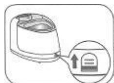
1. Placer la cuve démontable et fixer la fermeture. Si la cuve n'est pas placé correctement, le bouton de sécurité ne fermera pas facilement et l'appareil ne fonctionnera pas.
