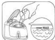
3. Remplir la cuve d'eau. S'assurer que le niveau ne dépasse pas la marque *max*. L'appareil pourrait être endommagé s'il fonctionne sans eau.
