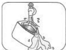
9. Ouvrir la fermeture, extraire la cuve et la nettoyer avec de l'eau. La sécher ensuite avec un linge sec.
