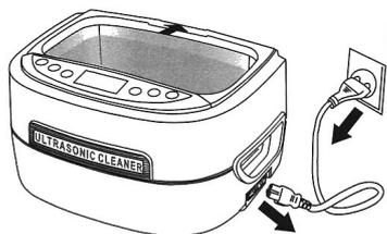
**5** Lorsque le nettoyage est complet, débranchez le câble, levez le couvercle et retirez le panier avec les pièces. Videz l'eau par la zone du renforcement. Nettoyez la cuve et séchez-la.
