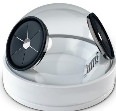
La cámara, (no incluida) es un producto complementario para uso en conjunto con el Microarenador. Se trata de una cámara de extracción utilizada en los procesos de chorreado con el objetivo de no permitir que el excedente del óxido de aluminio y las impurezas producidas en el proceso de chorreado sean liberadas en el ambiente.
