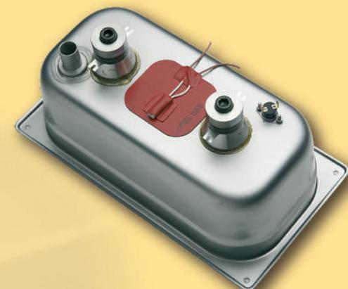
El baño dispone de dos potentes transductores tipo Sándwich con una potencia total de 100 W. transmitida a la cuba. Su frecuencia de trabajo (40 Khz.) ofrece un compromiso óptimo entre sonoridad y poder limpiador.
