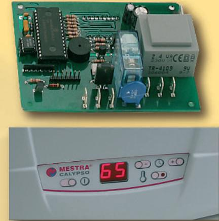
Un control electrónico se encarga de la selección y ejecución de tiempos. Dispone de señales acústicas de aviso y display digital de 7 segmentos.
