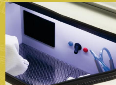
La maniobra de cambio de vaso se ha simplificado. Basta con mover a ambos lados una palanca situada en el interior de la cámara para seleccionar el vaso deseado. Intuitivo y práctico a la vez. El pedal de accionamiento es del tipo electro-neumático, por lo que su manejo es mucho más cómodo que el de los pedales neumáticos convencionales.
