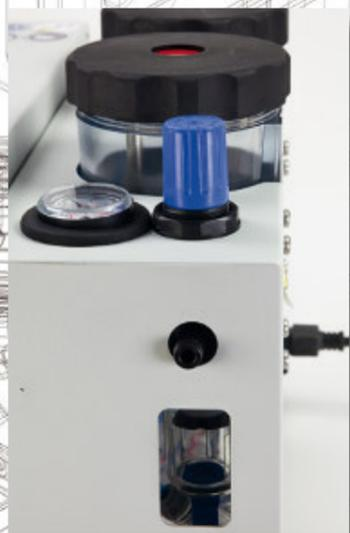
En cuanto al mantenimiento del aparato, todo el sistema de soplado puede desmontarse de manera rápida, sencilla y sin herramientas para solucionar pequeñas obstrucciones. Una práctica ventana permite visualizar el nivel de condensados en el filtro del manoregulador. La purga de este líquido se realiza automáticamente. Los filtros silenciadores, sólo se deben cambiar una vez al año. (Se entiende con un uso profesional normal).
