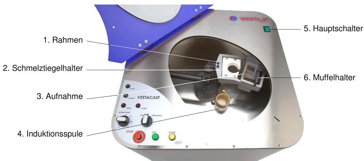
Abb. 2: Kammer mit Schleuderarm
