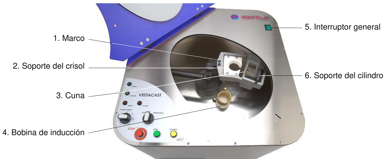
Fig. 2: Cámara de colado con el brazo
